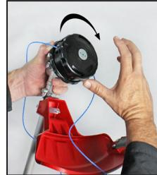
4. Girar el cabezal a la derecha hasta tener 8" de hilo.
