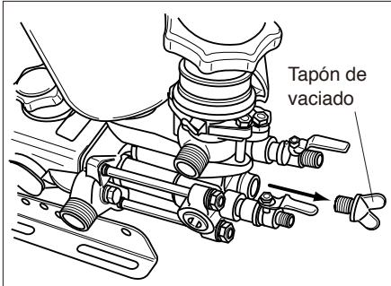
El agua debe ser extraída completamente durante el invierno para prevenir la congelación. La operación relativa se efectúa según los elementos 11-18 indicados en el procedimiento de la operación.
