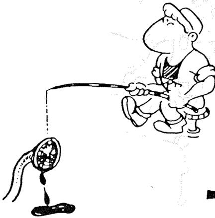
Saque del tanque de agroquímico el filtro de la manguera de succión.
