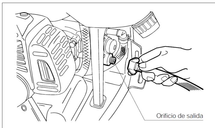
Conecte el extremo del tubo flexible al orificio de salida del pulverizador.
