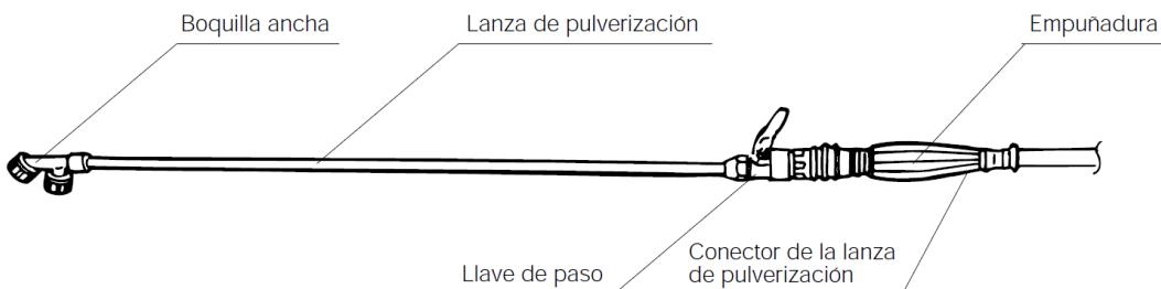
Antes de montar la boquilla, compruebe que las juntas se encuentran en su lugar. Coloque la boquilla en la lanza y conecte ésta a la empuñadura, asegurándose de la firmeza de la conexión. Compruebe la posición de las juntas antes de apretar el tornillo. Si aprieta demasiado el tornillo, puede pasarlo de rosca o romper la junta. Es importante aplicar el par torsión adecuado.
