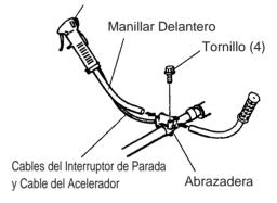
Carcasa del Cable del Acelerador
