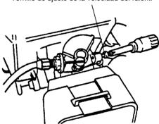
Para el modelo BC320H es de 2700-3300 min<sup>-1</sup> (o justo por debajo de la velocidad del embrague). La herramienta conectada no tienen que estar en movimiento y el motor no debe calarse (pararse) a la velocidad de ralentí.
